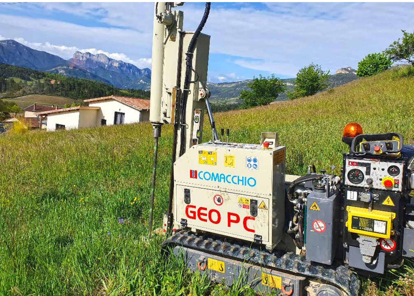
Il GEO PC è un penetrometro dinamico automatico montato su carro cingolato in gomma idoneo per campionature, prove SPT (Standard Penetration Test), DPH (Dynamic Heavy Probes) e DPSH-A (Dynamic Super Heavy Probes). Il GEO PC può essere equipaggiato con una testa di rotazione per effettuare perforazioni del terreno a bassa profondità.
